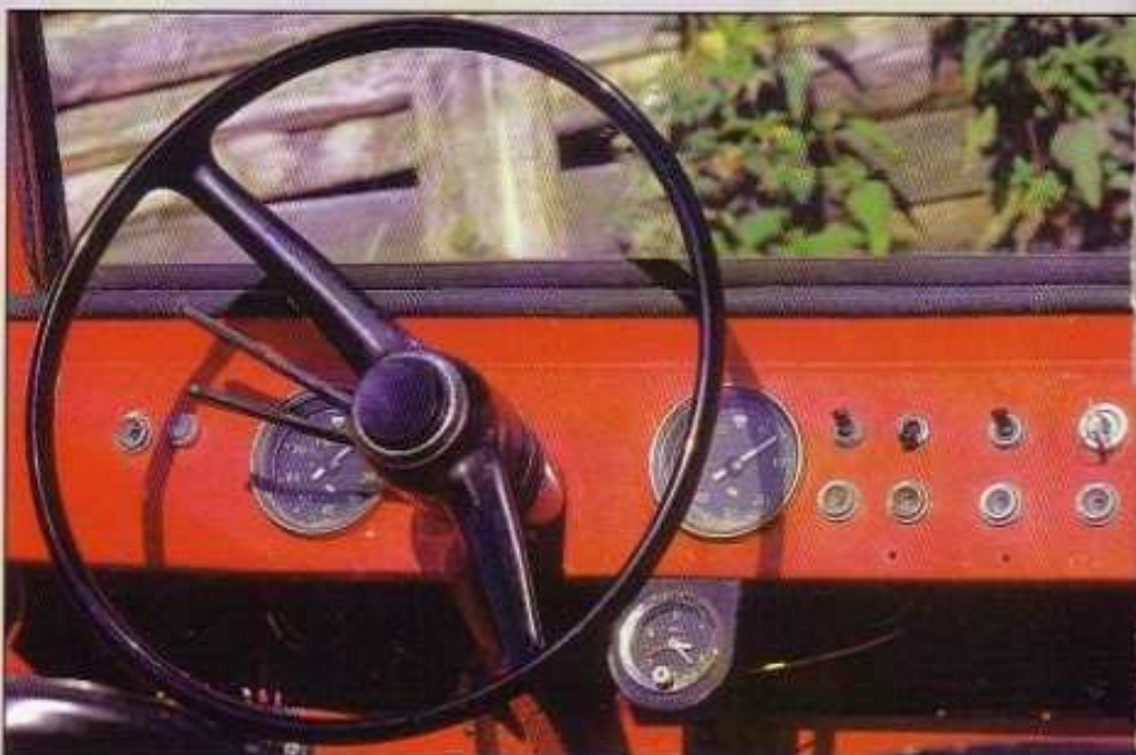
Un petit compte-tours, accessoire spécifiquement italien a été monté sur le tableau de bord.
