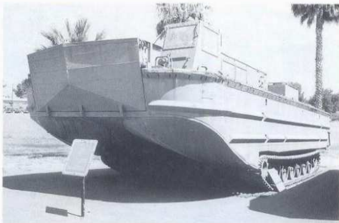
Ci-contre. Le LCAC, un engin construit en 1968 par Food Machinery Corp., est conçu dans un style Catamaran. Le train chenillé est celui d'un M-60. Il devait emporter 30 tonnes de matériel ou 250 soldats équipés.
