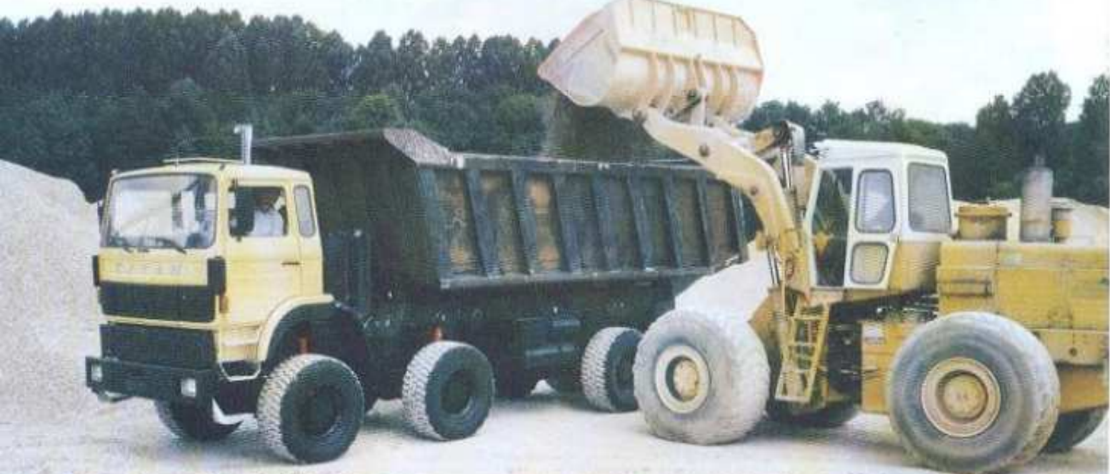
En bas. Ce TTR 340 est livré à l'entreprise Baptistan & Bardin, qui exploite des carrières de granulats près de Mont-de-Marsan (Landes). Il est doté d'une benne Decauville à compas. L'entreaxe des roues avant a été augmenté pour une meilleure répartition des charges.
